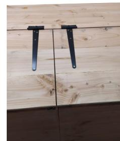
.12 ouvrir les panneaux sur charnière vissées et assembler les câbles de retenue avec le maillon rapide + les outils fournis.
